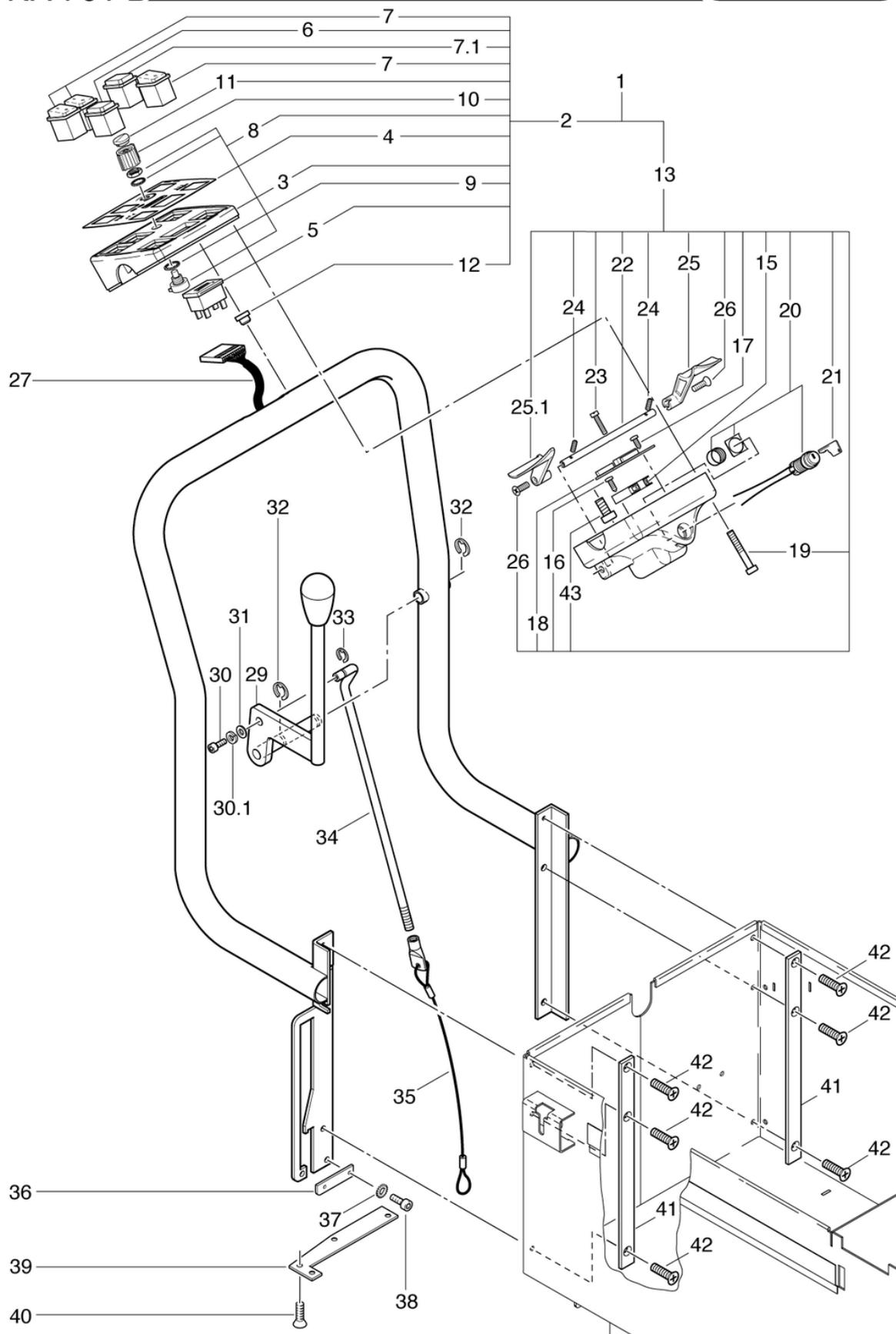
RA 701 B - Steuerkasten und Stossbuegel
