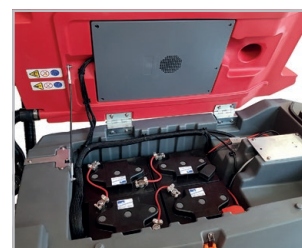
Compartiment des batteries
