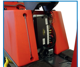
Chargeur intégré et électronique bien accessible
