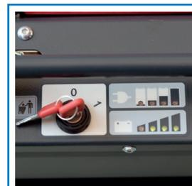
Affichage du niveau de charge de la batterie et du chargeur intégré
