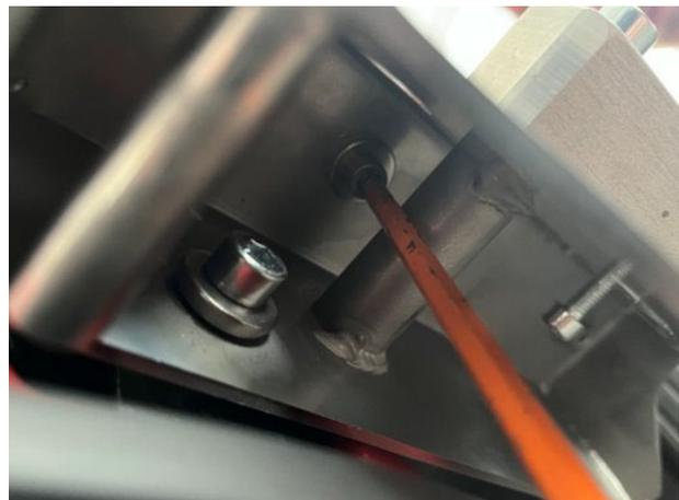
Fixer la roue de transport avec la vis M6 et la rondelle aux pos. 2 + 3 (selon page 3) sur le réservoir d'eau propre. Il peut éventuellement être utile de retirer le ressort de pression à cet effet (meilleure accessibilité pour la clé à molette).
