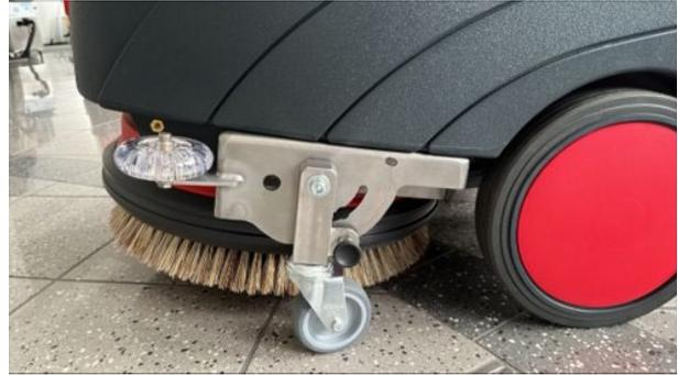
Roue de transport entièrement montée avec ressort de pression.
