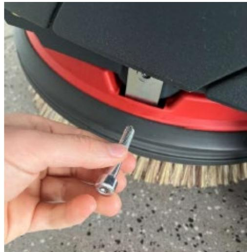
Desserrer la vis de la tête de brosse. La vis n'est plus nécessaire.
